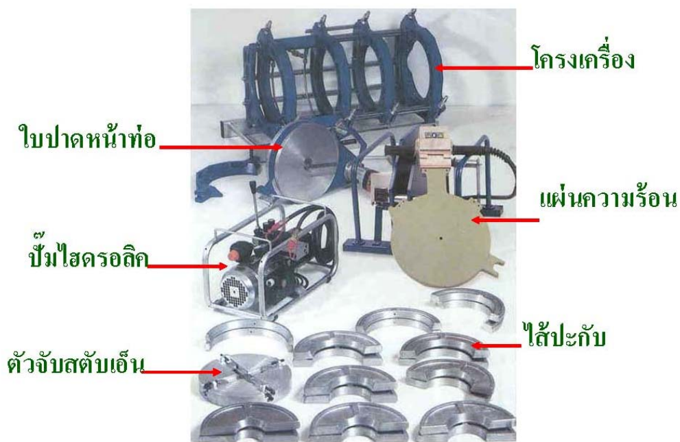
รูป 2-2 เครื่องมือเชื่อมท่อโพลีเอทิลีน (PE) [ที่มา : Wiik & Hoeglund Public Company Limited]
