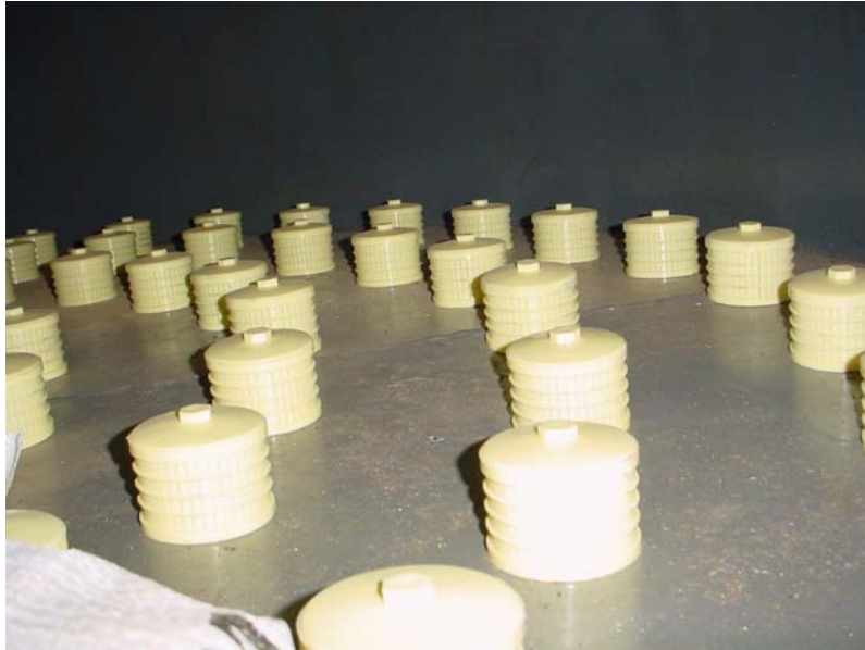
ภาพที่ 1 แสดงการวางหัวกรองน้ำประเภท Nozzles บนแผ่น Plate
